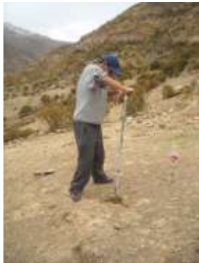
muestra de suelo con barreno
