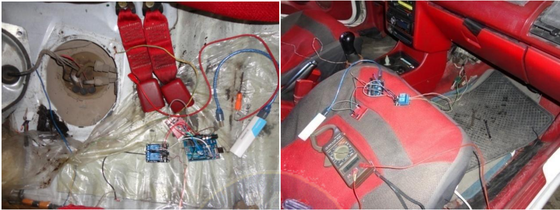
Figura 3.14: Montaje del Relé a un automóvil Ford Escort, conexión directo a la bomba de Gasolina a) y al relé original b)
