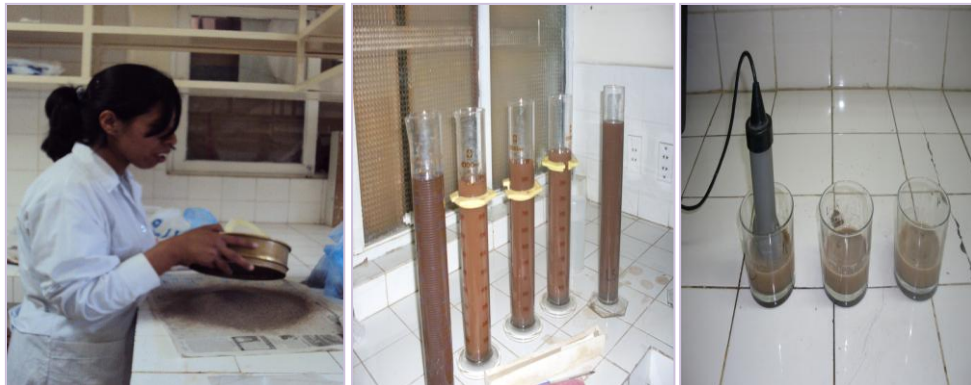
Figura 7. Tamizado de muestras; Figura 8. Muestras de suelo en probetas. Figura 9. pH y CE, Laboratorio – Facultad de Agronomía, La Paz.
