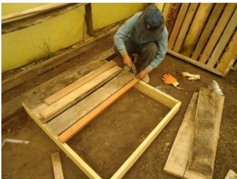
**FIGURA 7.** Armado de bandejas
