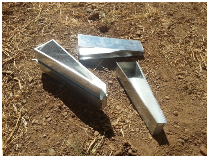
Figura 8. Colectores de partículas Big Spring Number Eight (BSNE)
