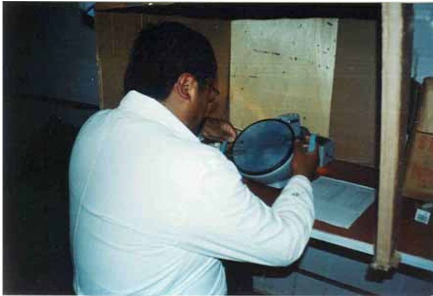
Midiendo el diámetro de la fibra, en el Lanametro
