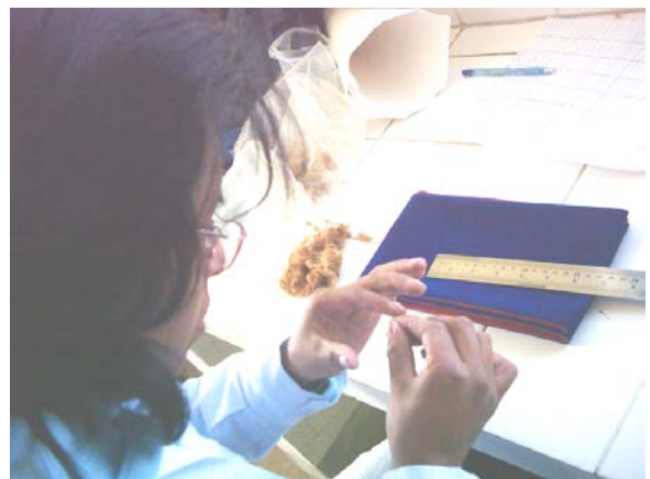
11. Obtención de la longitud de fibra
