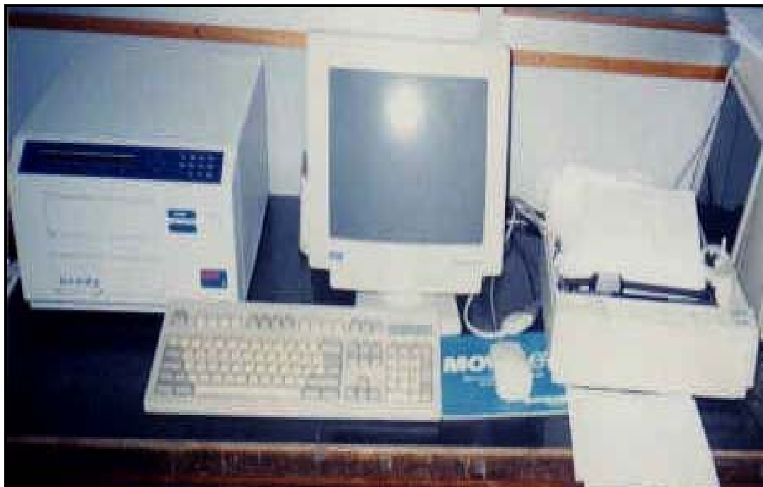
FOTOGRAFIA 11. Equipo Espectrofotómetro de Celdas (Longitud de onda de trabajo 750 nm).
