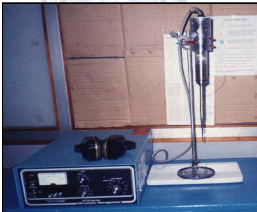
FOTOGRAFIA 12. Equipo Sonicador de muestras.
