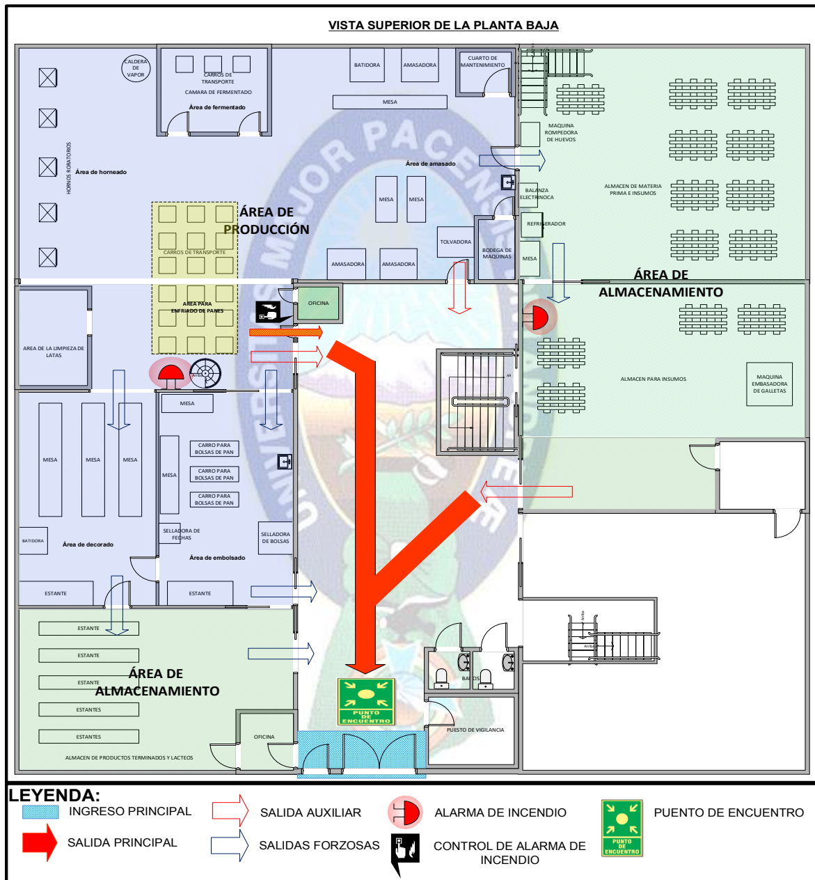
CUADRO N° J1. VÍAS DE ESCAPE Y SISTEMA DE ALARMA DE LA PLANTA BAJA.
