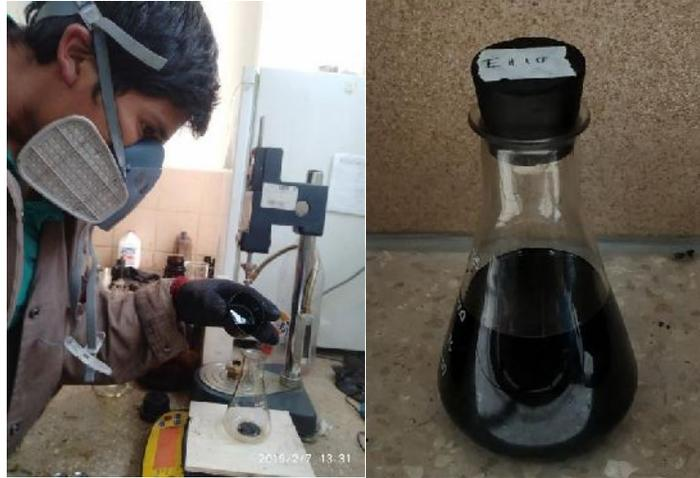
**Figura 30: Ensayo de Solubilidad en Tricloroetileno**
