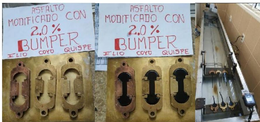
Figura 37: Ensayo de Recuperación Elástica
