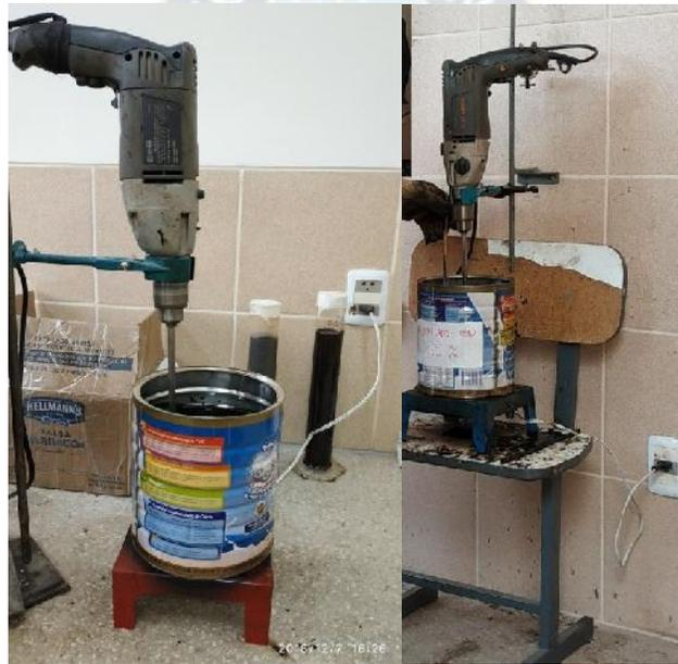
**Figura 23: Equipo Utilizado Para la Modificación del Asfalto**
