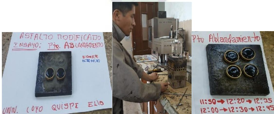
Figura 29: Ensayo de Punto de Ablandamiento (Anillo Y Bola)
