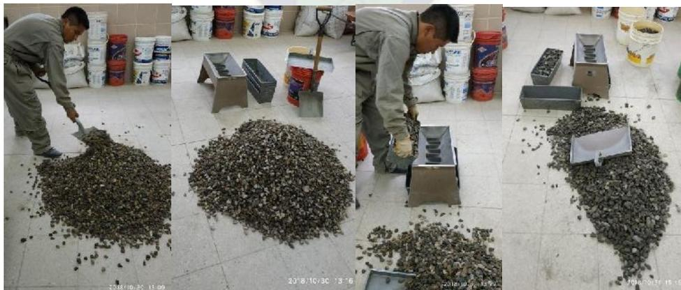
**Figura 14: Cuarteo Mecánico de los Agregados**
