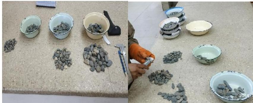
**Figura 20: Ensayo de Partículas Planas y Alargadas**
