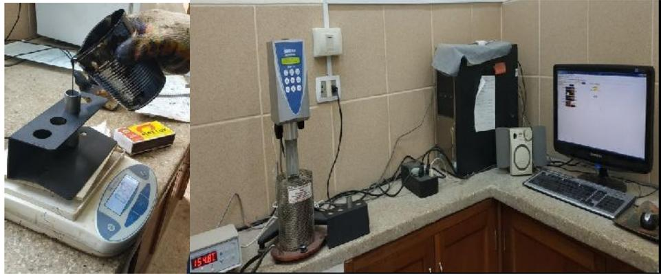
**Figura 35: Ensayo de Viscosidad Brookfield**
