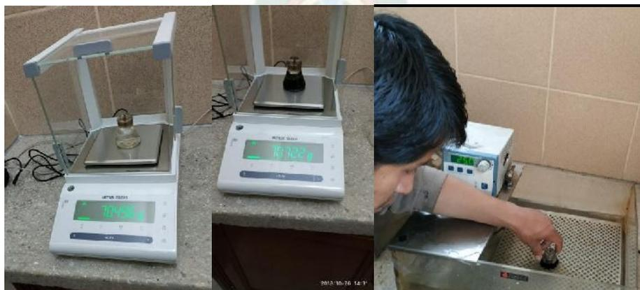
**Figura 25: Ensayo de Peso Específico**
