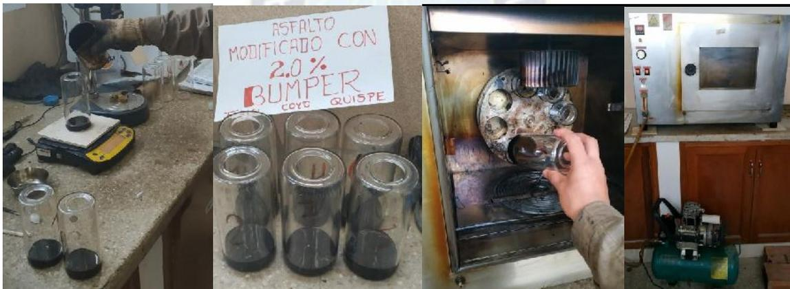
**Figura 33: Ensayo de Película Delgada Rotatoria**
