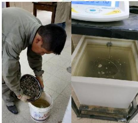
**Figura 15: Ensayo de Peso Específico y Absorción del Agregado Grueso**
