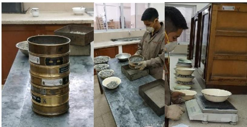
**Figura 18: Ensayo de la Granulometría de los Agregados Pétreos**
