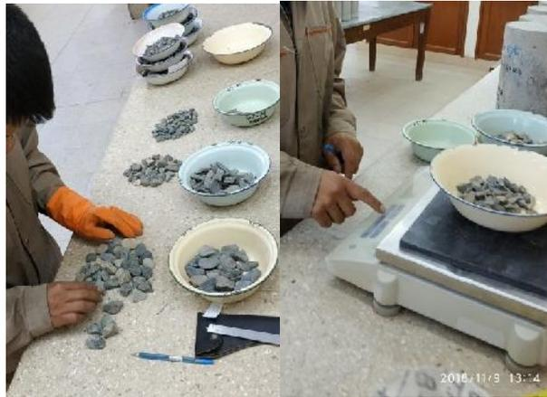
**Figura 19: Ensayo de Caras Producidas por Fracturas**
