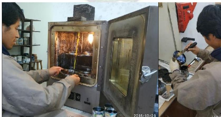
**Figura 32: Ensayo de Película Delgada Giratoria**
