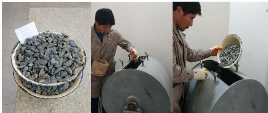
**Tabla 20: Ensayo de Desgaste en la Máquina de los Ángeles**
