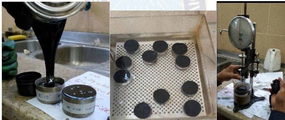
**Figura 26: Ensayo de Penetración**
