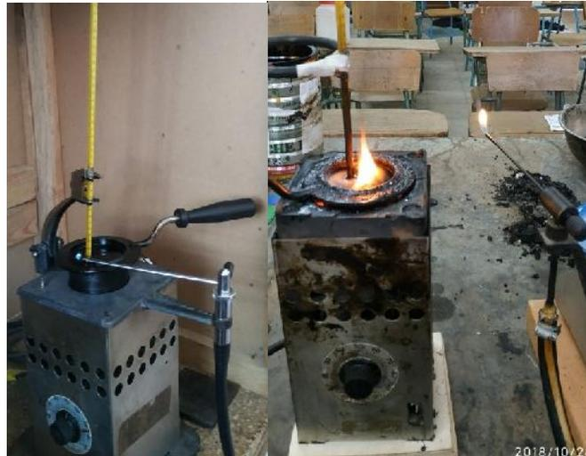
**Figura 27: Ensayo de Punto de Inflamación y Combustión**
