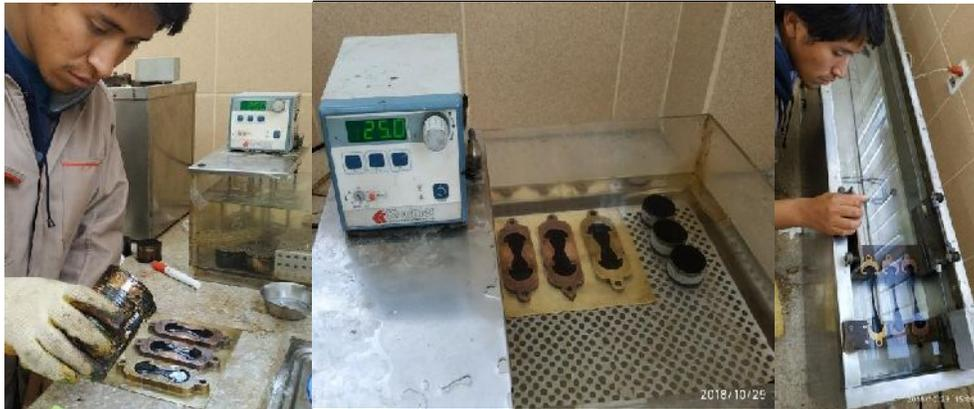
**Figura 28: Ensayo de Ductilidad**
