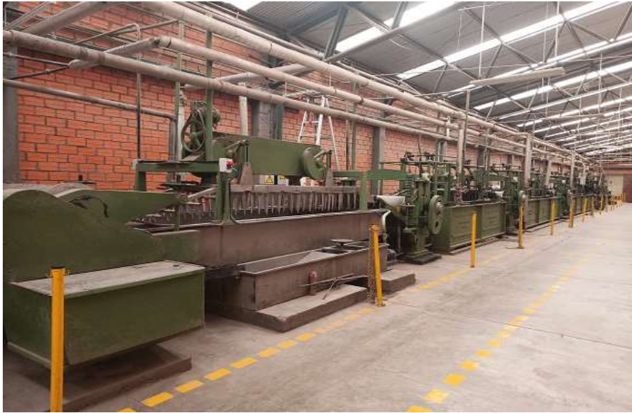
Fotografia 10 Maquinaria de Teñido de Fibra
