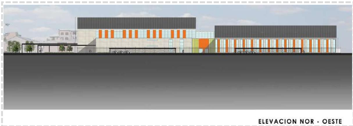
El juego de niveles en las fachadas, la utilización de vacíos y llenos, el hormigón armado como principal material en muros exteriores generando simpleza, cuenta con ventanas de vidrio templado y perfiles de aluminio para el ingreso de luz natural, la integración con la plaza pública situada en la parte frontal el proyecto generando sombras en áreas de circulación y descanso mediante pérgolas.
