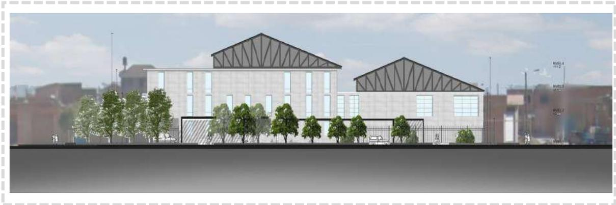
El manejo de cubierta a dos aguas con una inclinación a 20% con estructura metálica vista, generando ventilación al patio que existe en el interior del equipamiento. Rejas para dar seguridad al usuario y al equipamiento.
