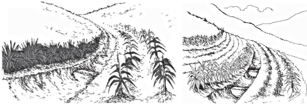
Figura 9: Zanjas de Infiltración
