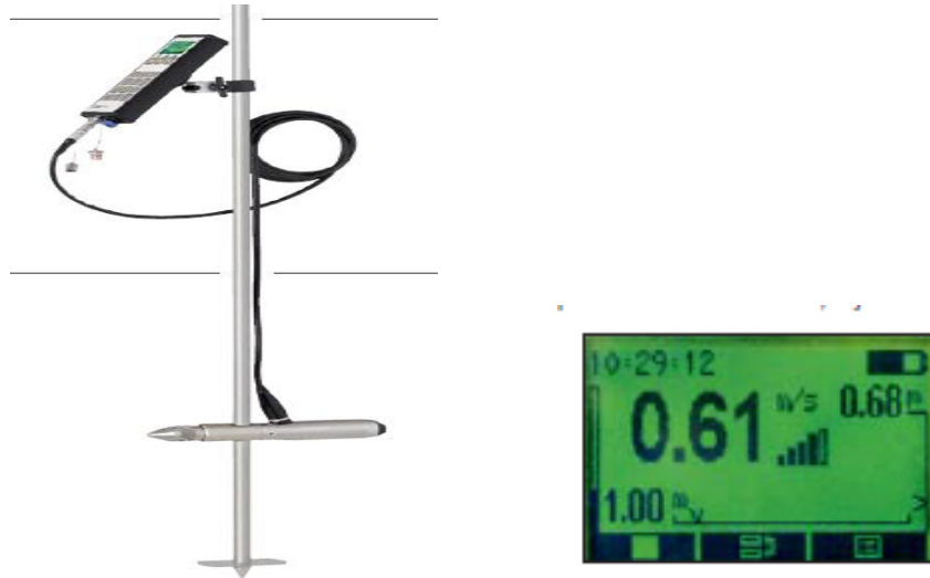
Fig. (2.26) (e) Molinete, aparato registrador de velocidad en un río
