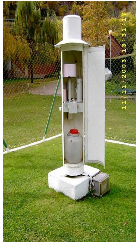
Fig. (2.14) Pluviómetro - Pluviógrafo (CEDEX, 1994)
