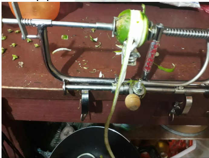
Figura N° 4.2 Equipo cortador de cascara de Limón
