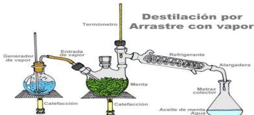
Figura N° 2.2 Destilación por arrastre de vapor
