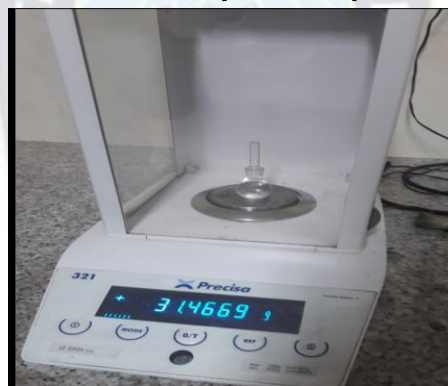
Figura N° 4.18 Determinación del peso del picnómetro
