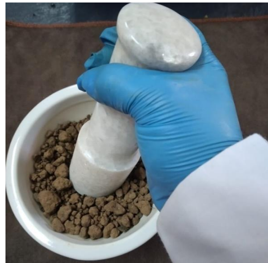
Fotografía 4. Mortero, para triturar agregados grandes y pequeños
