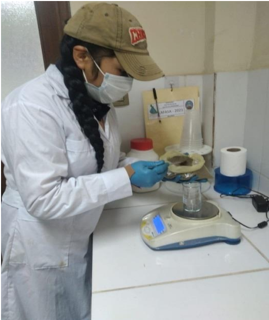
Fotografía 23. Pesado de las muestras para pH y CE
