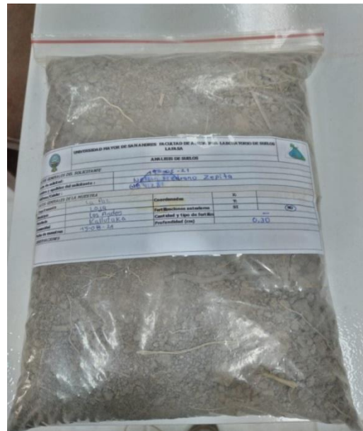
Fotografía 12. Muestra de suelo herméticamente cerrado y codificado.
