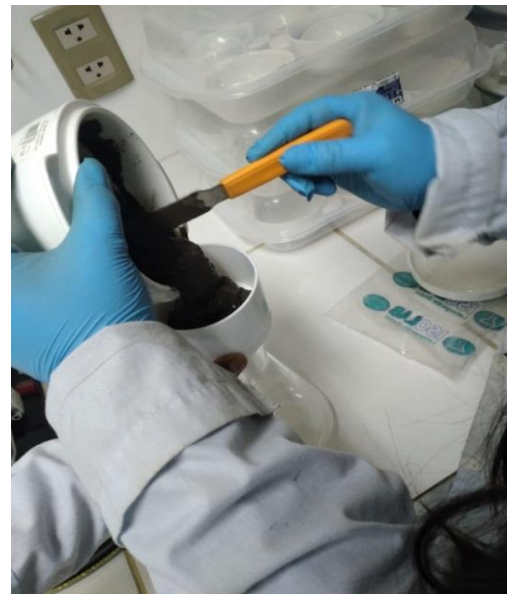
Fotografía 20. Determinación de Conductividad Eléctrica en extracto de saturación.
