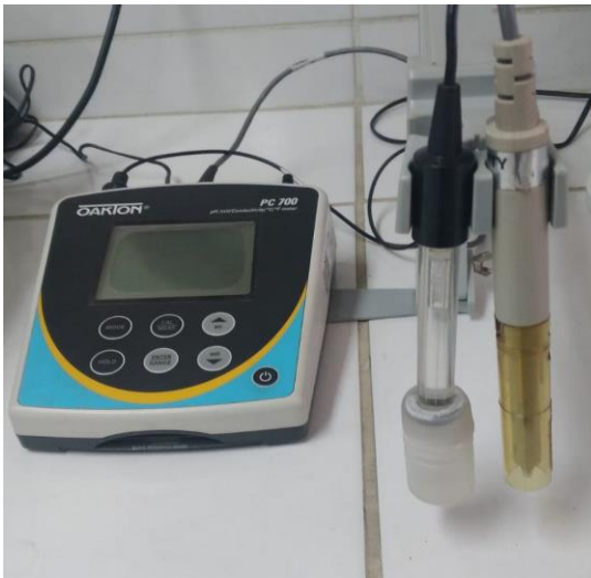
Fotografía 3. pH-metro instrumento para la lectura de pH.
