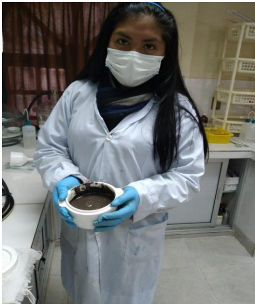
Fotografía 27. Saturacion de la muestra de suelo
