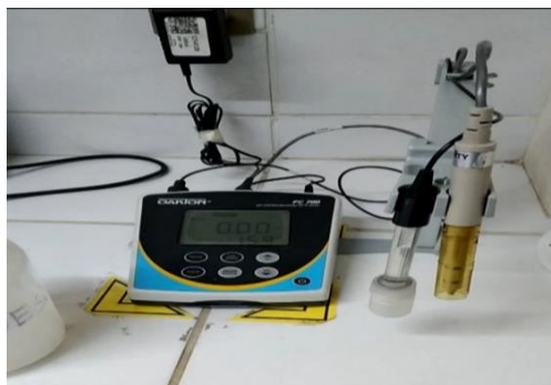
Figura 5. Equipo de laboratorio pH-metro y conductivimetro
