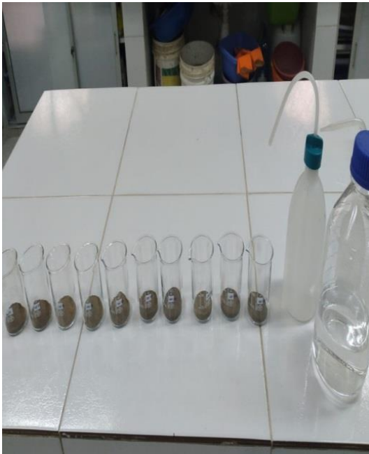
Fotografía 7. Muestras de pH y CE relación suelo/agua
