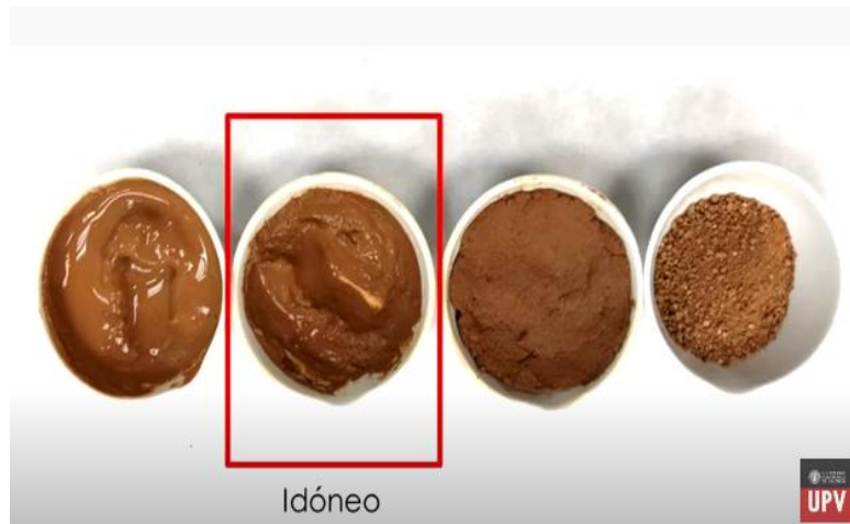
Figura 2. Extracto de pasta saturada del suelo
