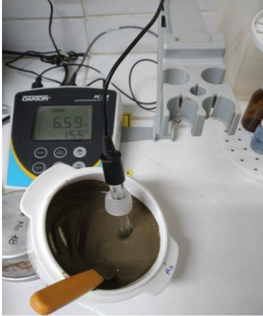
Fotografía 25. Lectura del pH en pasta saturada
