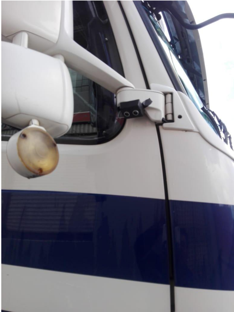
Figura 20. INSTALACION DEL SENSOR EN EL LADO DEL PASAJERO. Fuente: Propia
