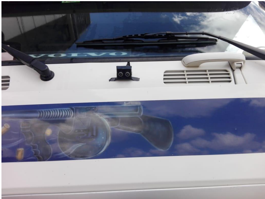
Figura 24. INSTALACION DEL SENSOR EN LA PARTE FRONTAL. Fuente: Propia
