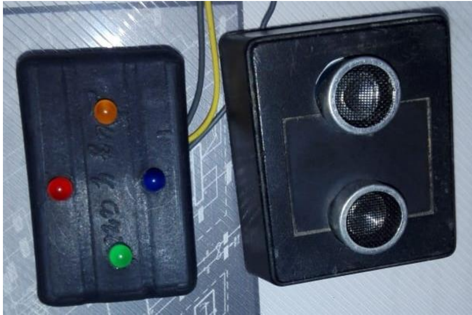
Figura 17. Luz alarma y sensor a instalar en el vehículo. Fuente: Propia
