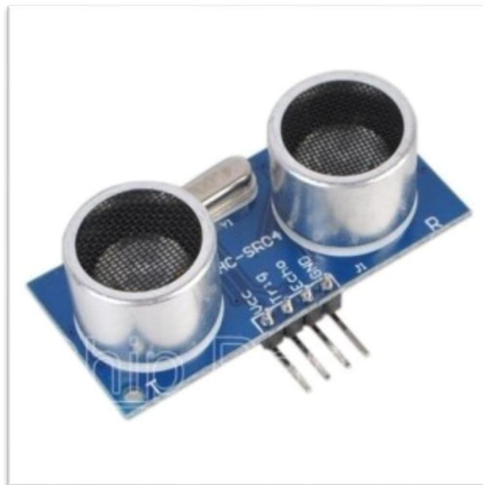
Figura 8. Sensor de proximidad fuente: https://www.prometec.net
