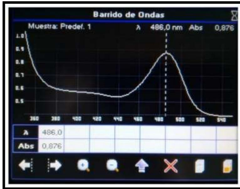
Nota. En el barrido se determinó como máxima longitud de onda 486,0 nm.
