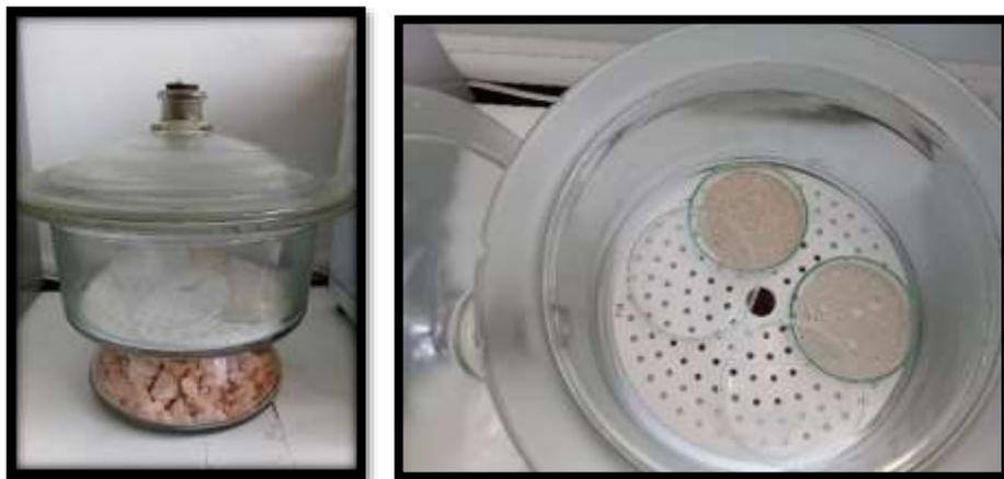
Nota. El precipitado obtenido se procede a secar en un desecador despues de haber sido deshidratada a 60 °C por 24 hrs.. Elaboración propia
