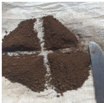
Figura 10: Cuarteo de muestra
