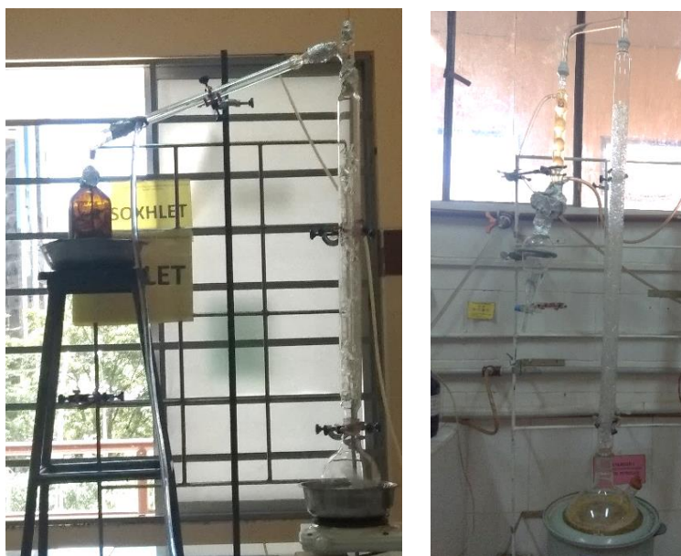
Figura 26. Destilación fraccionada del éter de petróleo a partir de gasolina
