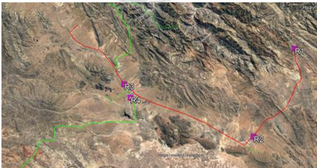
Figura 6.9 Ubicación de reconectadores en el Alimentador Tablachaca
