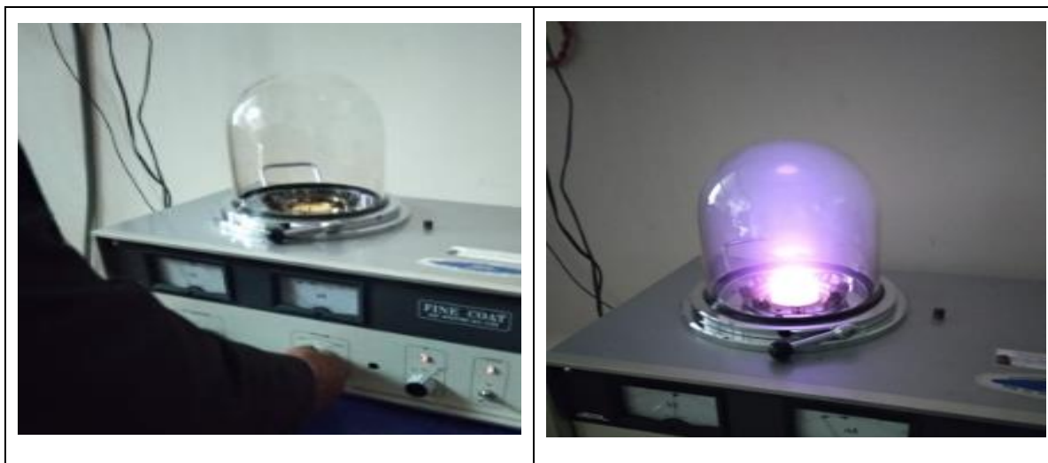
Imagen 21. Proceso de recubrimiento de oro de la muestra en la cámara de vacío
