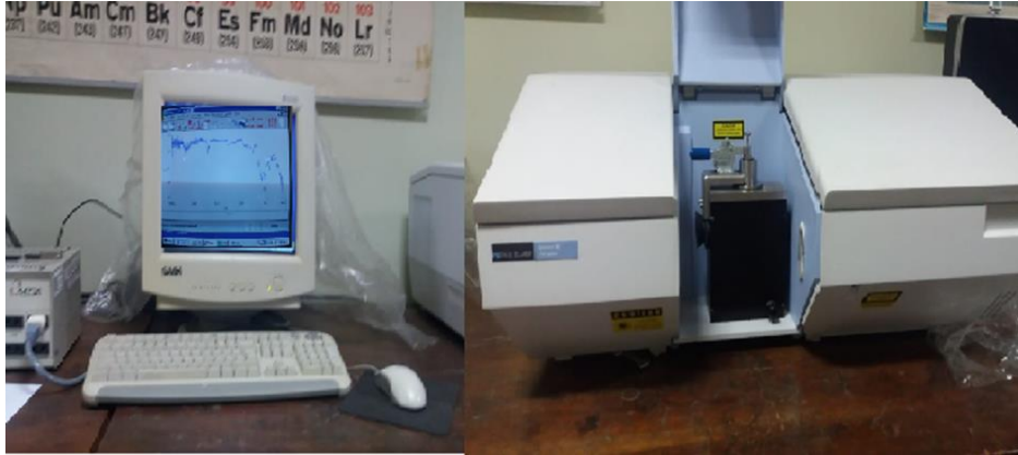
Imagen 18. Equipo Perkin Elmer Spectrum BX FT - IR System.
