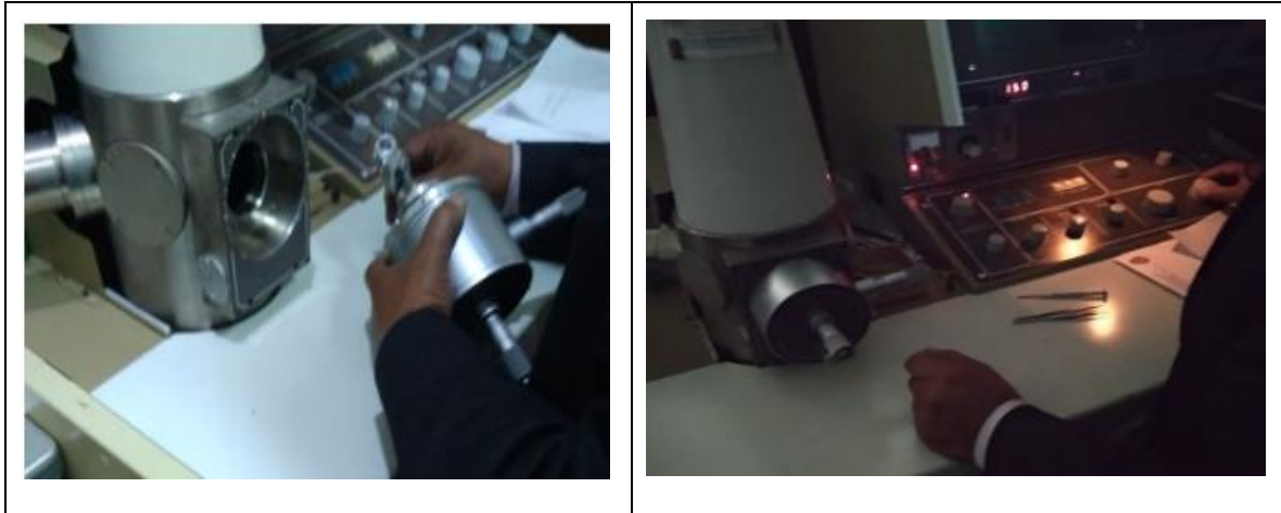
Imagen 22. Porta muestra de la cámara de SEM
