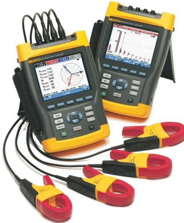
Figura #25.: Analizador de redes Fluke 434
