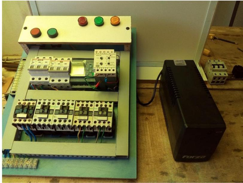
*Figura #40.: Realizando la prueba del tablero de transferencia*
