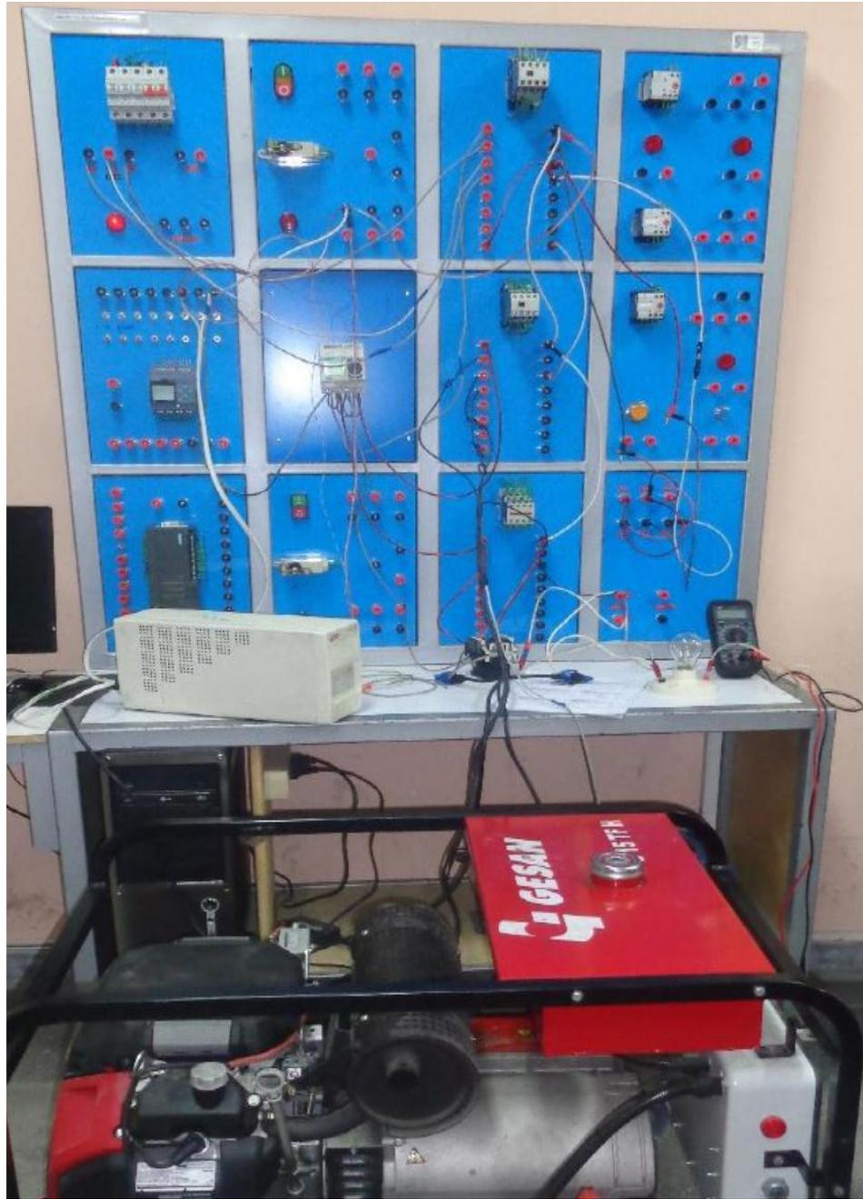
*Figura #27.: Realizando pruebas del sistema de transferencia*
