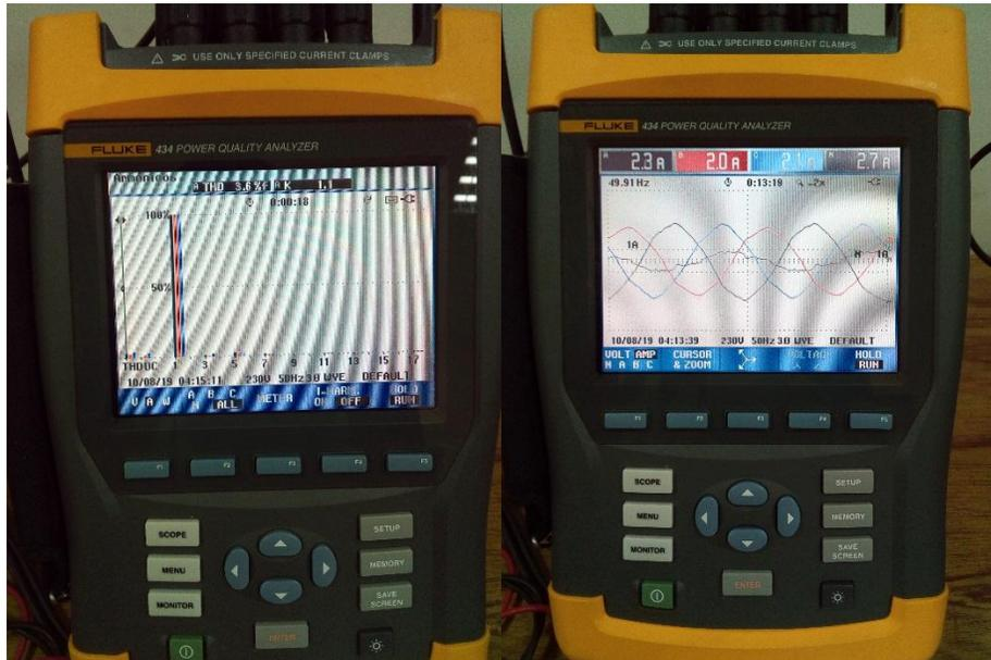
Figura #36.: Medición de armónicos en motor trifásico.
