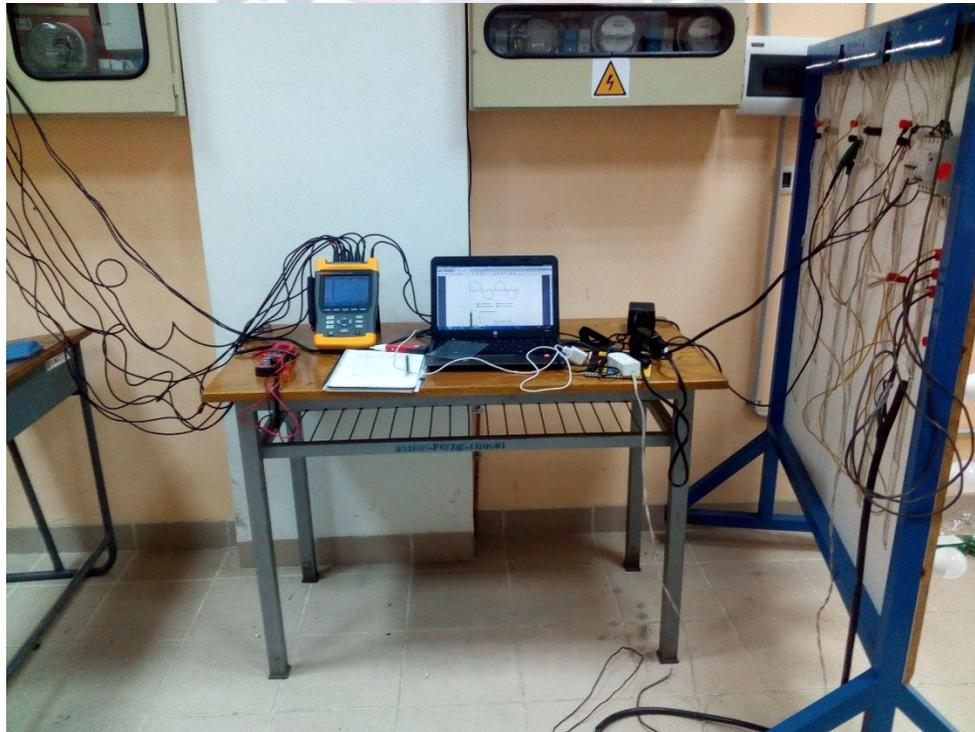
Figura #29: realizando las respectivas tomas de datos con el fluke 434.
