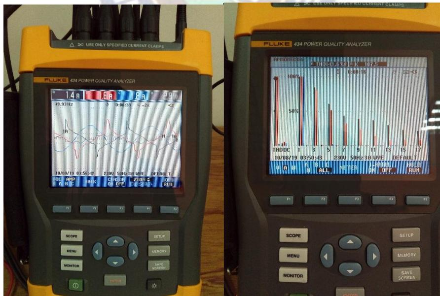
Figura #35.: Medición de armónicos en luminarias.
