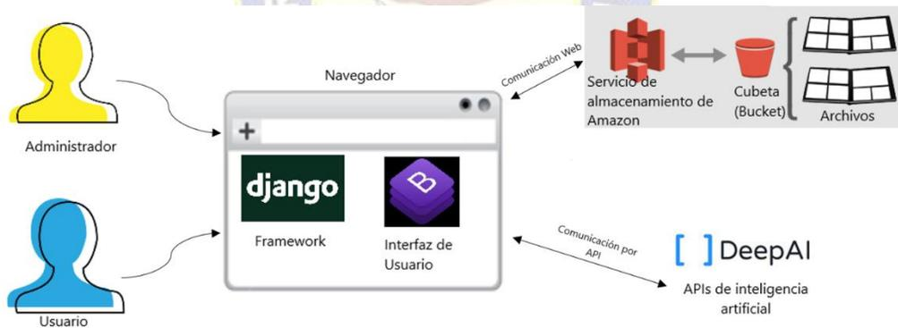
**Figura 3.2. Estructura de la aplicación web**
