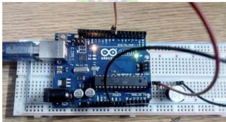
Figura 3.25: Implementación del sensor Buzzer.
