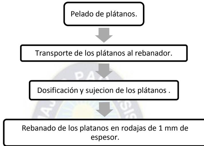
FIGURA: 21. Proceso de elaboración de rodajas de plátano. (Fuente: El Autor)
