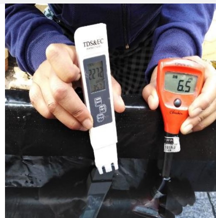
Control de PH y conductividad eléctrica
