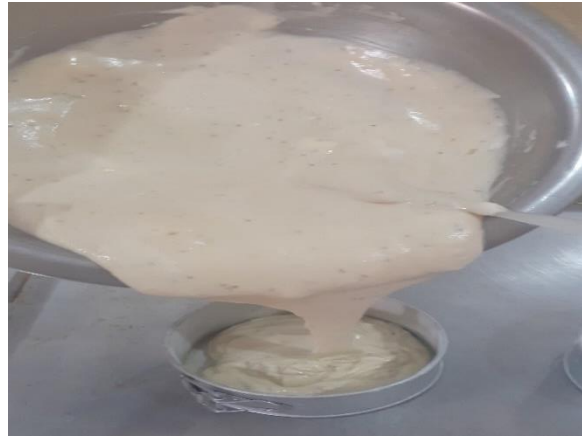
Figura 32. Vaciado de la Mezcla al Molde
