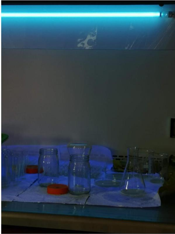
Figura 8. Irradiación con rayos U.V. cámara de flujo laminar.
