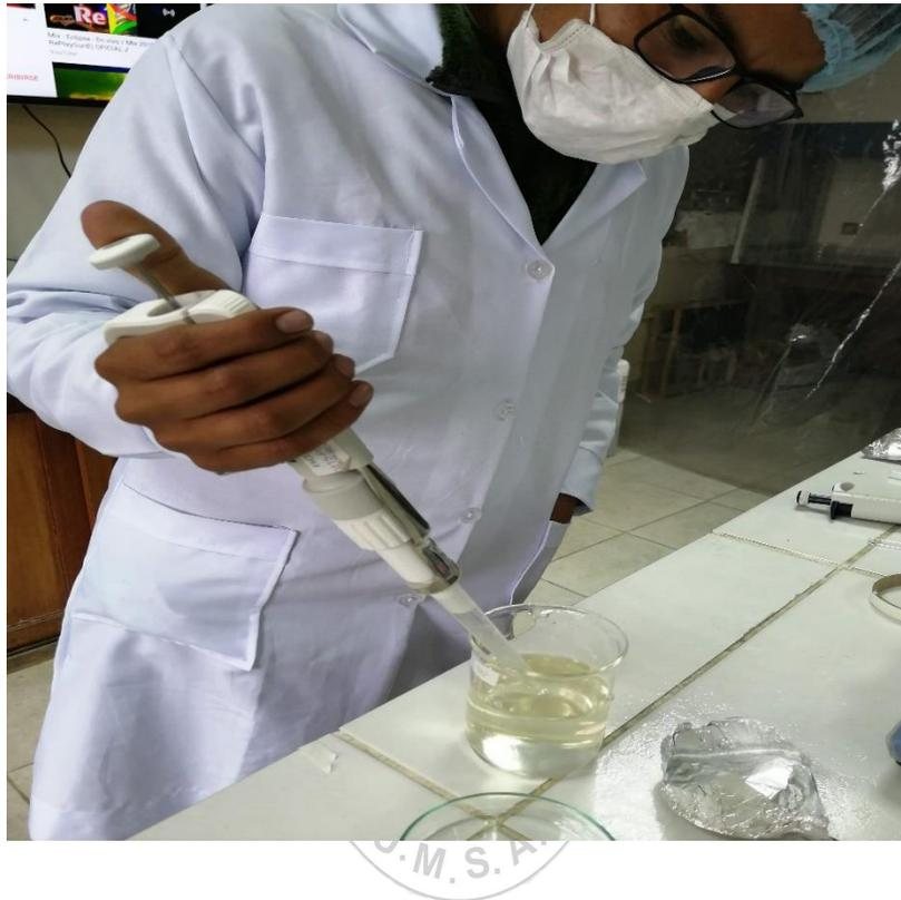
Figura 9. Dispensación de medios con micro pipeta.
