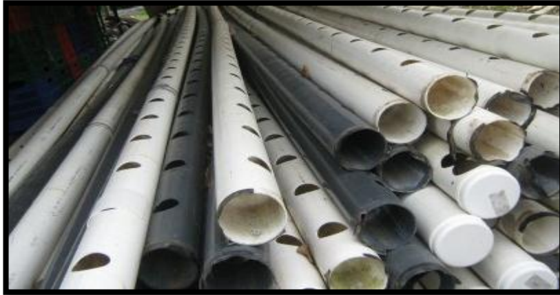
Tubos ya perforados con las medidas correspondientes.
