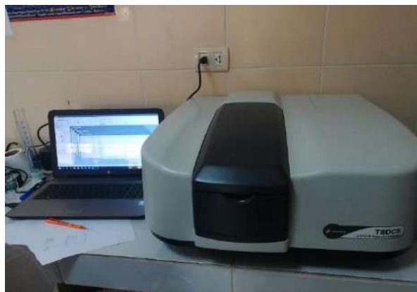
Figura 17. Espectrofotómetro UV-Visible (PERSEE)
