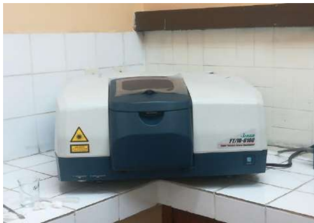
Figura 18. Espectrofotómetro Infrarrojo con Transformada de Fourier (JASCO)
