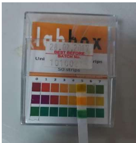
Figura 48. Determinación de pH de gel terapéutico
