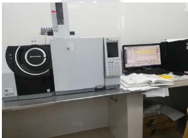
Figura 20. Espectrómetro GCMS - QP 2020(SHIMADZU)
