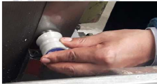
Figura 39. Detectores de Ultrasonido en el cuerpo de la MEC-FR-02
