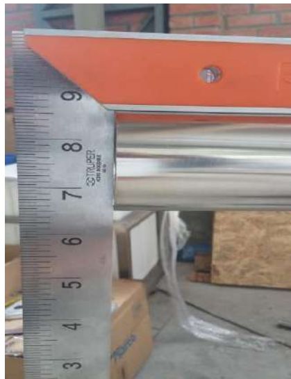
Fig. 3.30 Verificación de ángulo con escuadra. Fig. 3.31 Ductos de salida.
