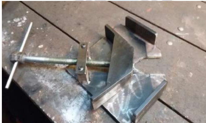
Fig. 3.26 Fabricado de escuadra.
