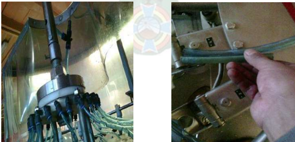
Fig. 3.14 Cambio de ductos plasticos en distribuidores.
