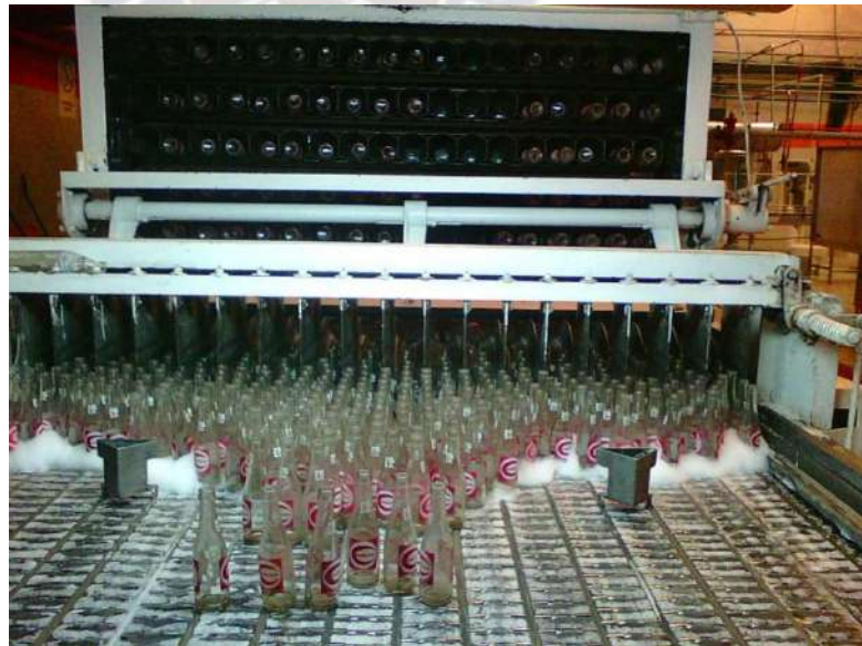
Imagen N° 4.8 Maquina lavadora de botellas.
