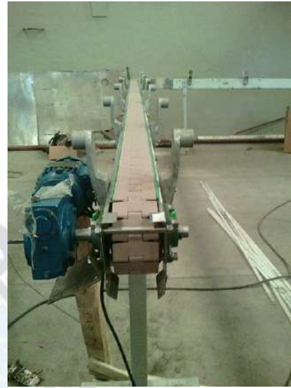
Fig. 3.28 Armado del soporte. Fig. 3.29 Ensamblado del motor.
