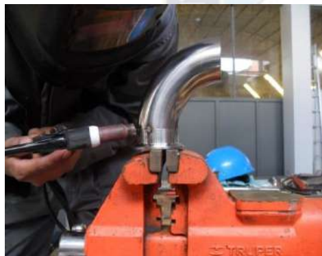
Fig. 3.32 Punteo (codo y unión clamp). Fig. 3.33 Armado de ductos.
