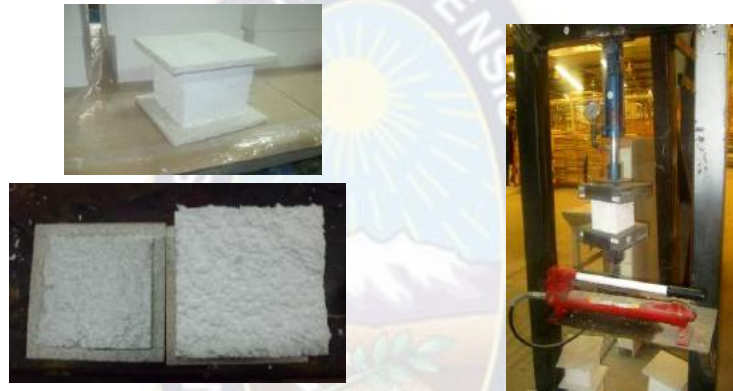
Probeta de prueba de tracción según norma DIN 53430 Equipo de tracción uniforme para EPS
