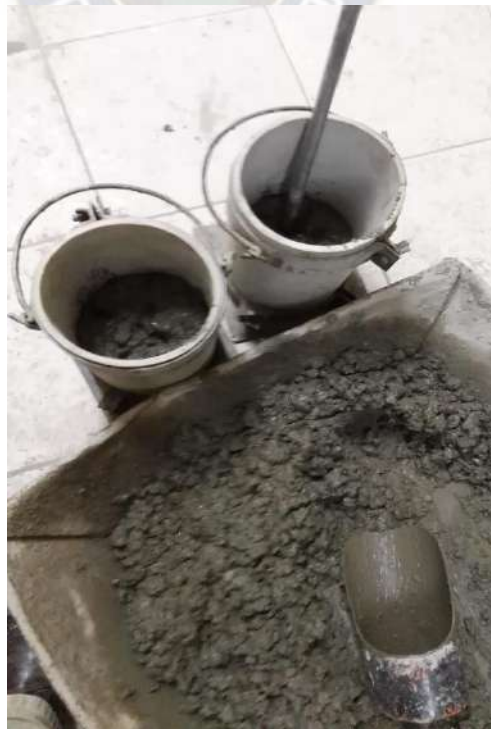
Figura 15. Llenado de la primera capa del cilindro con hormigón fresco, (Fuente: Elaboración Propia).
