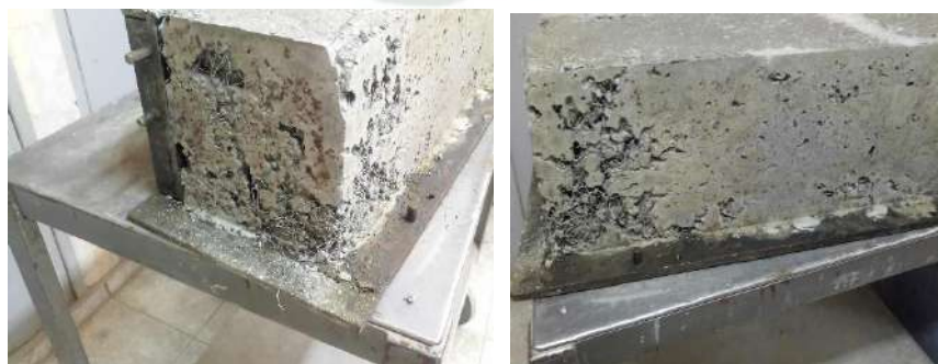
Figura 22. Vacíos en los especímenes debido a la saturación de fibras.
