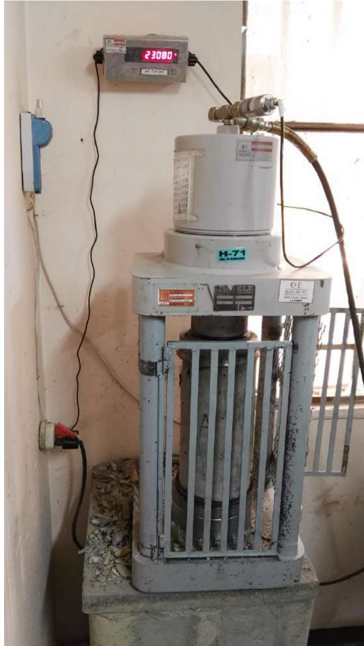
Figura 30. Posición correcta del espécimen antes de ensayar, (Fuente: elaboración Propia).
