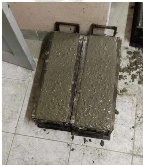
Figura 17. Vigas elaboradas y listas para ser enrazadas, (Fuente: Elaboración Propia).
