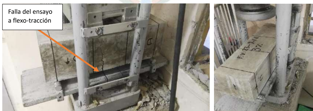
Figura 21. Ensayo a flexo-tracción de vigas al 3% de adición de fibras de acero, (Fuente: Elaboración Propia).
