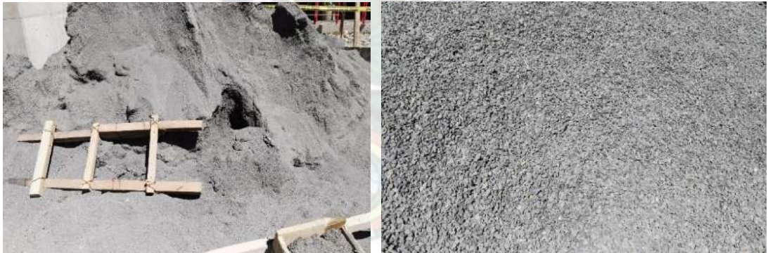
Figura 14. A la izquierda arena y a la derecha grava chancada, (Fuente: Elaboración Propia).
