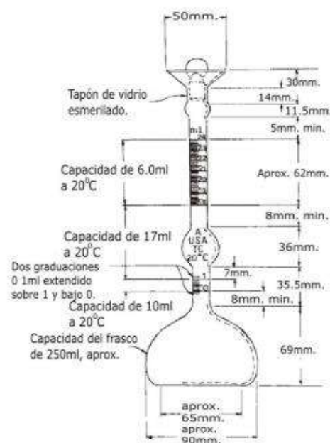
Figura 24. Frasco de Le Chatelier, (Fuente: Manual de ensayos de suelos y materiales - Hormigones, volumen 4, ABC).
