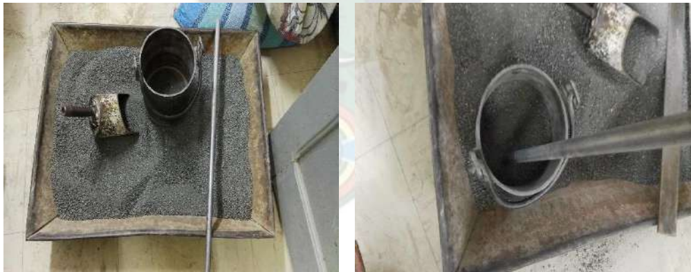
12. Proceso del ensayo de Peso Unitario Compactado de la arena, (Fuente: Elaboración Propia).
