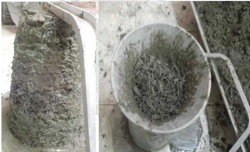
Figura 23. Vacíos creados por la acumulación de fibras en el hormigón al realizar el ensayo de asentamiento, (Fuente: Elaboración propia).
