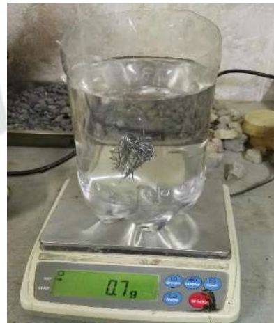
15. Determinación del Peso Específico de las fibras de acero por el principio de Arquímedes, (Fuente: Elaboración Propia).
