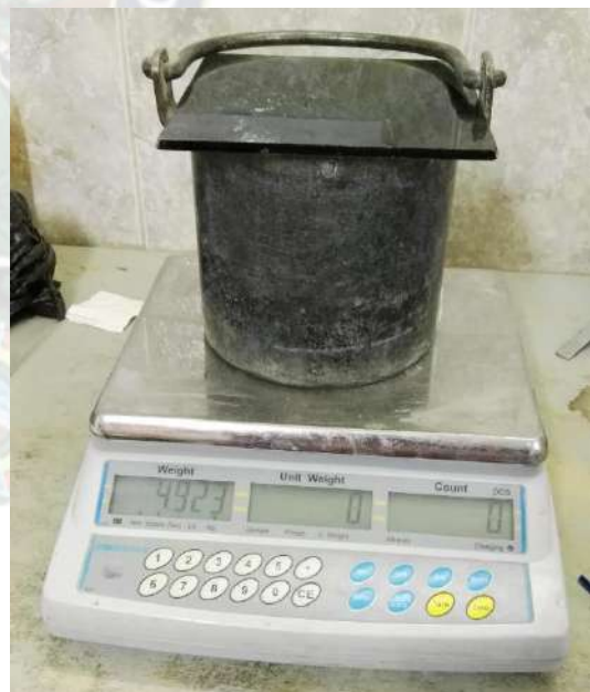
10. Calibración de los recipientes para el ensayo de Peso Unitario de los agregados, (Fuente: Elaboración Propia).
