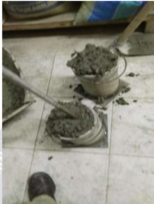
Figura 16. Llenado y varillado de la capa final antes del enrasado, (Fuente: Elaboración Propia).
