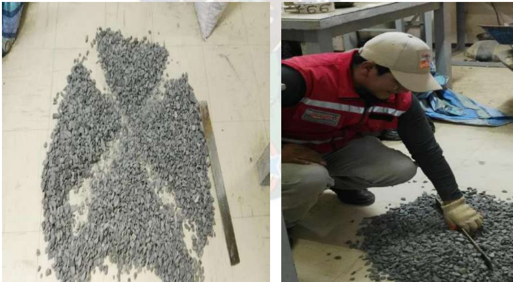
2. Proceso de cuarteo manual de la grava, (Fuente: Elaboración propia).
