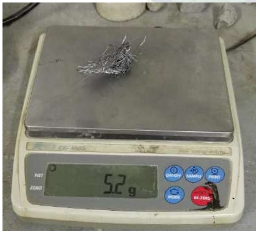
15. Determinación del Peso Específico de las fibras de acero por el principio de Arquímedes, (Fuente: Elaboración Propia).
