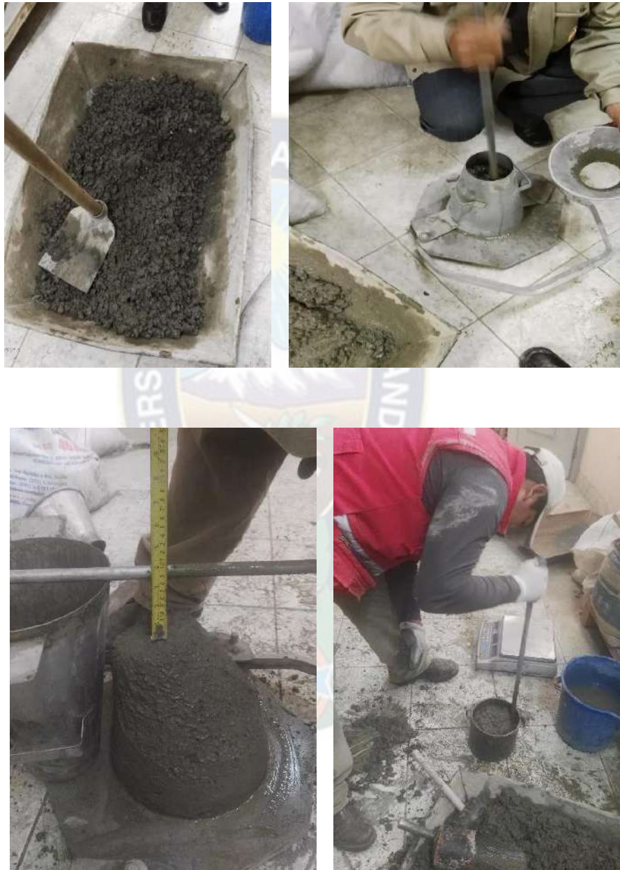
16. Proceso de mezclado de los ingredientes y ensayos de Asentamiento y Peso Unitario del hormigón fresco, (Fuente: Elaboración Propia).
