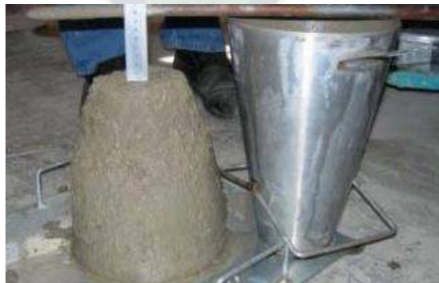
FIGURA 5-1 PREVITEC S.R.L.: Consistencia Método Cono de Abrahams. 2015.
