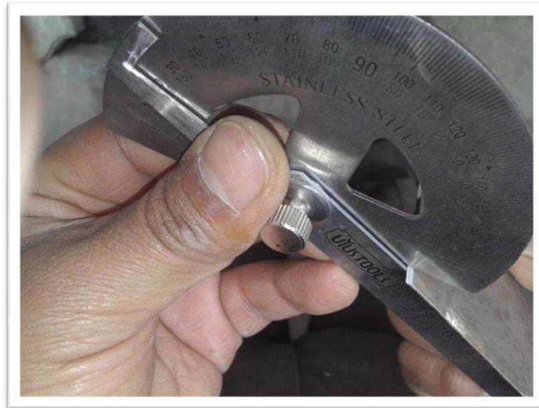
Con este dato se podrá hacer las pruebas correspondientes a la fuerza de corte necesaria que necesita cada plátano, también es importante mencionar que se utilizara el ángulo de corte estilo japonés de un solo lado de corte, que está en los parámetros de 0° a 45° con un solo lado de corte como se puede apreciar, por lo tanto se decidió utilizar una cuchilla la cual será afilado a 35° de inclinación (Véase figura 9), para poder obtener un buen rebanado en cada rodaja de plátano.
