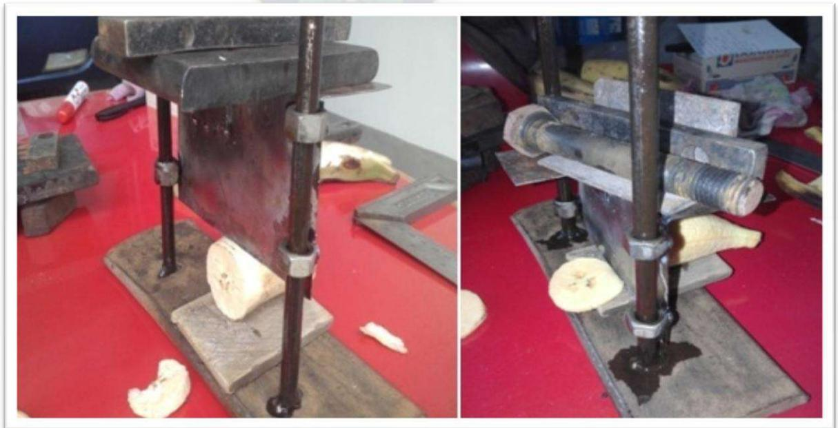
La masa de la cuchilla para el corte nos da 110 g, este peso habrá de sumarse al peso final de cada medida en las pruebas a ser realizadas, para obtener el peso total de la masa empleada en cada prueba.
