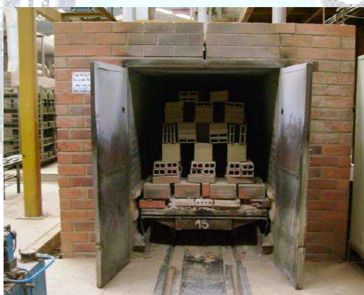
Figura: 11 Ingreso de ladrillos al horno túnel
