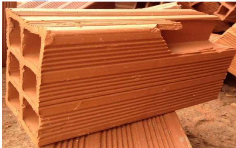
Figura: 13 Ladrillo destinado para los cascotes.
