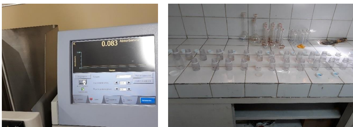
Figura 14. Medición de contenido de sodio intercambiable en el suelo
