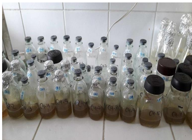
Figura 5. Grupos de frascos conteniendo medio mínimo con glucosa o biol en diferentes concentraciones, para determinar si el biol puede ser utilizado como fuente de carbono.
