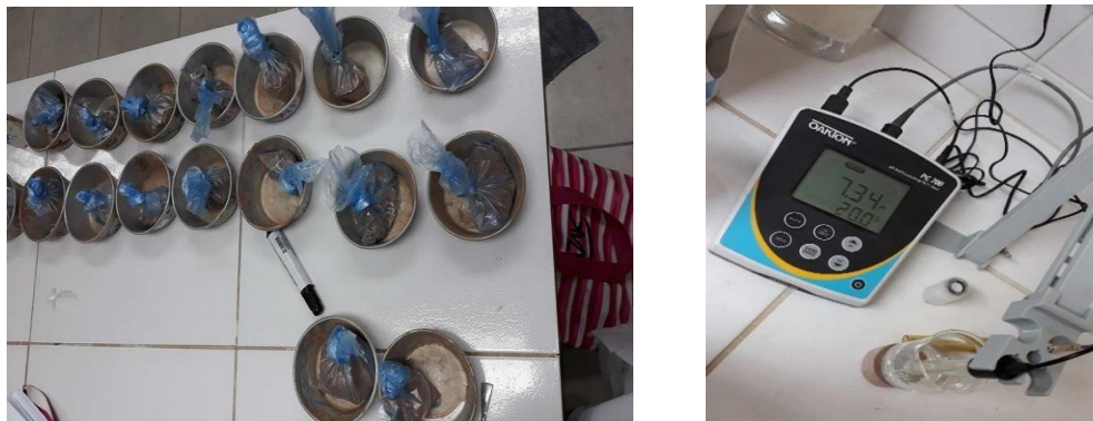
Figura 12. Preparación y medición de pH en el suelo
