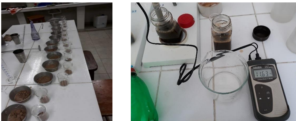
Figura 13. Medición de pH en el suelo
