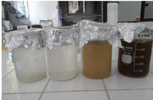
Figura 4. Medio mínimo de sales con diferentes concentraciones de glucosa o biol. como fuente de carbono.
