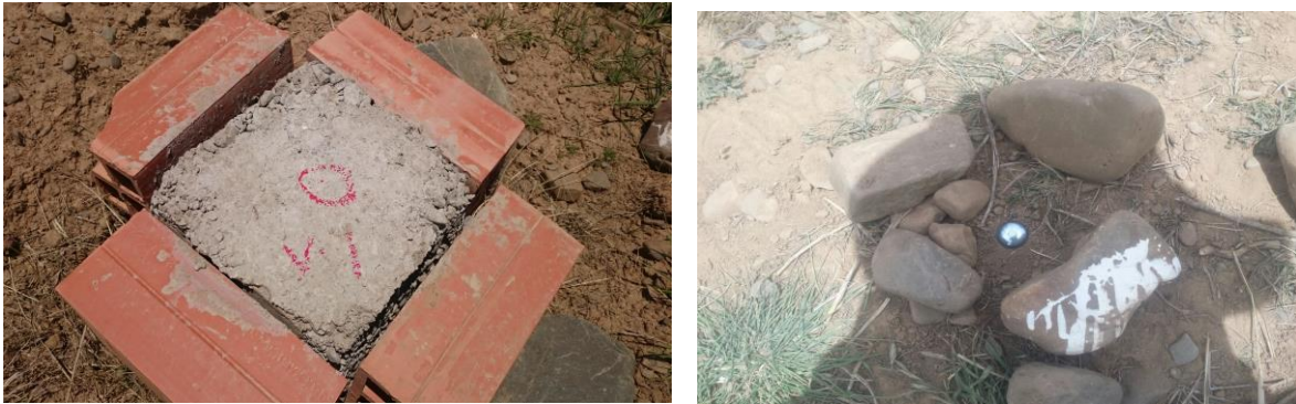
Figura 24: (Fotografía) Puntos mojonados y de paso FUENTE: elaboración Propia
