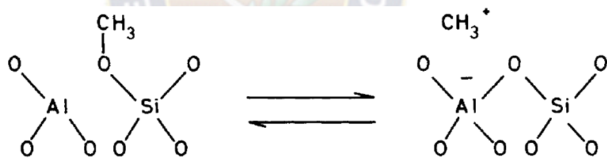
Figura N° 14. Mecanismo de estabilización de carga, por interacción electrostática con especie reactiva formada. [14]
