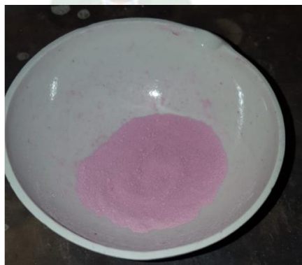
Figura N° 27. Ejemplo de muestra impregnada con nitrato cobaltoso.
