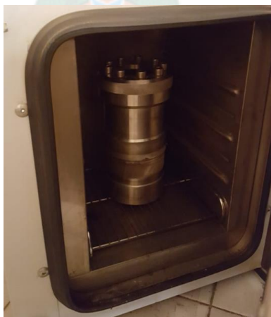
Figura N° 23 Autoclave de acero inoxidable utilizado para lixiviación ácida, posterior a tratamiento hidrotermal
