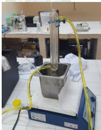
Figura N° 24. Sistema de reflujo utilizado para intercambio iónico.
