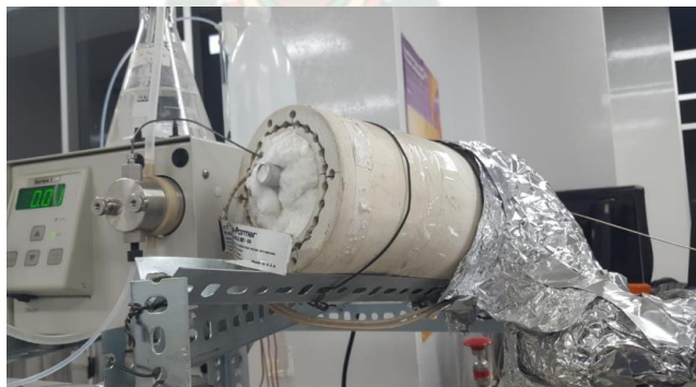
Figura N° 32. Sistema de inyección de líquidos y bomba de HPLC instalados en el reactor.
