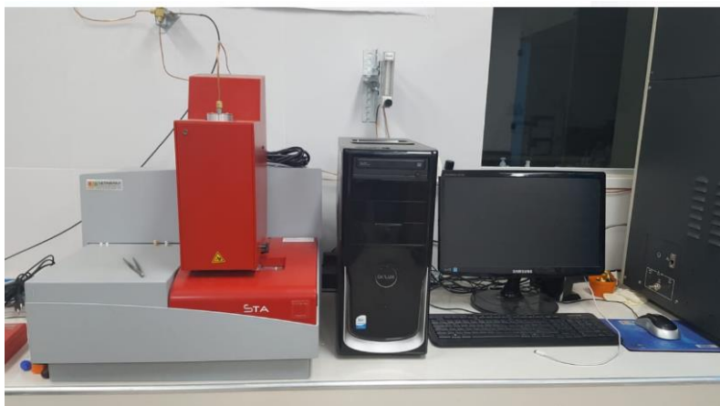
Figura N° 38. Equipo TG-DTA-DSC 1600° utilizado para la determinación de carbono tipo coke y compuestos C6+
