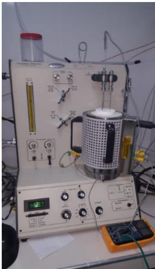
Figura N° 29. Equipo ChemBET TPR/TPD Quantachrom Analysis utilizado para las pruebas de TPR.
