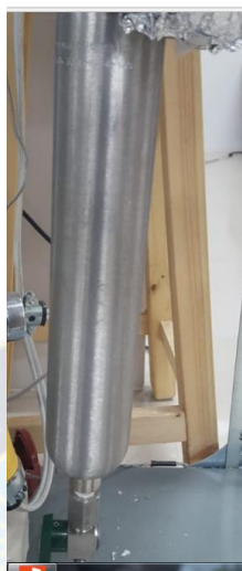
Figura N° 31. Trampa para líquidos instalada en el reactor.
