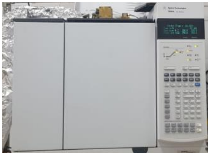
Figura N° 35. Cromatografo de gases utilizado para la identificación y cuantificación de productos de reacción.
