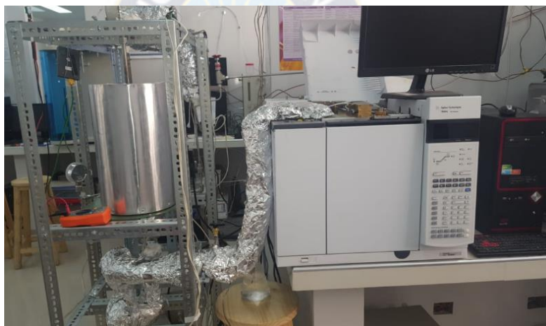
Figura N° 33. Salida del reactor acoplada en línea a un cromatógrafo de gases.
