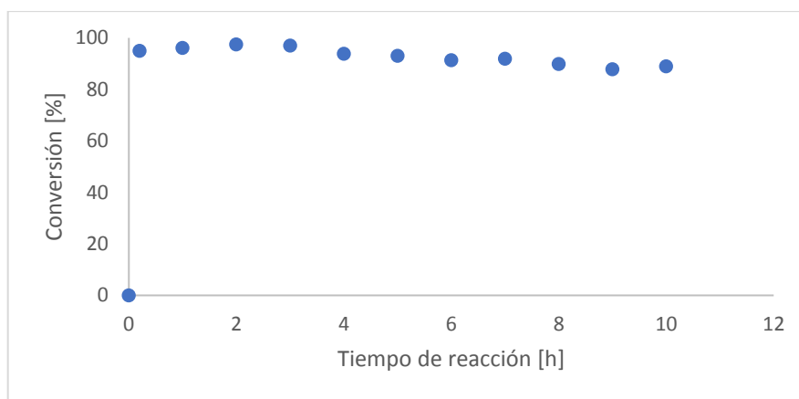
Figura N° 73. Conversión de metanol a lo largo de la reacción, sobre catalizador 25%Co/H-ZSM-5
