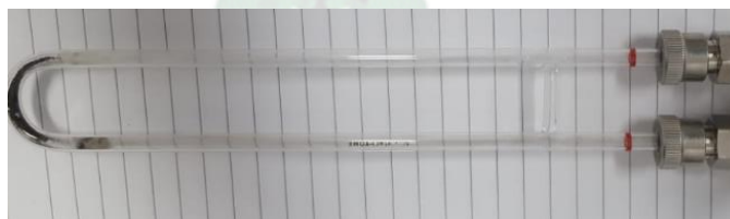
Figura N° 28 Celda de cuarzo con catalizador de catalizador.
