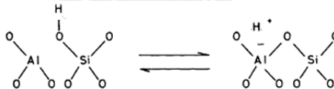
Figura N° 12. Equilibrio entre un silicoaluminato con acidez de Brönsted provocada por el protón ácido, y un ácido de Lewis debido a la presencia del Aluminio [14]
