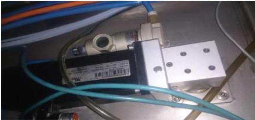
Fotografía 6 vista lateral cilindro neumático
