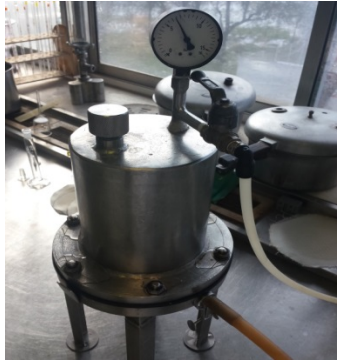
Figura 6 Equipo de filtración
