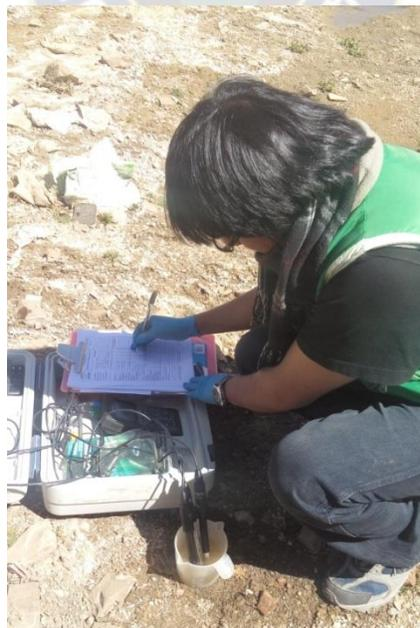
Figura 9. Toma de parámetros fisicoquímicos del muestreo
