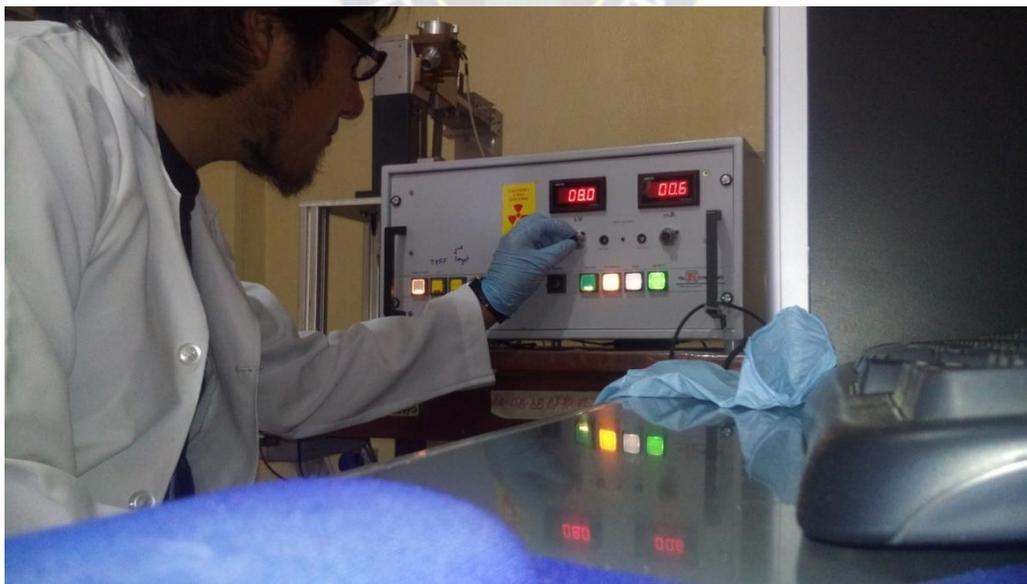
Figura 4. Control del voltaje y corriente del equipo de fluorescencia de rayos X
