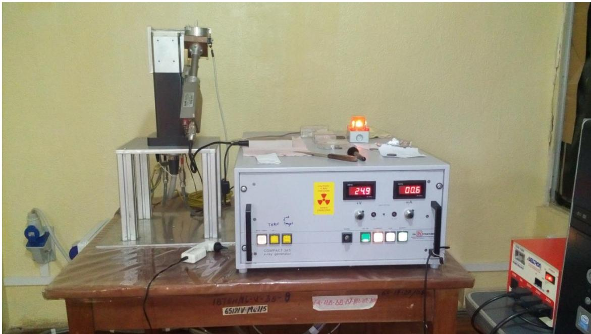
Figura 3. Equipo de fluorescencia de Rayos X Rx ITAL STRUCTURES modelo COMPACT 3K5
