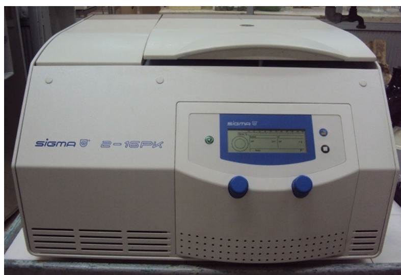
Figura 5. Centrífuga refrigerada multirotor modelo 2-16PK, marca sigma ®
