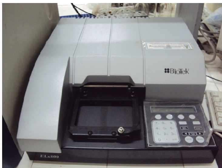
Figura 6. Lector en placas Epoch modelo ELx800 de la marca Biotek®
