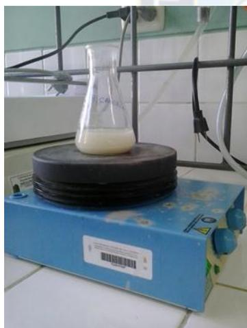
**Figura 16: fotografía de la muestra en agitación magnética**
