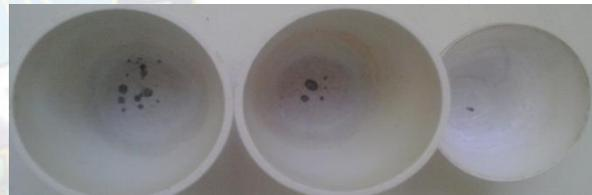
**Figura 14: crisoles con muestra incinerada**
