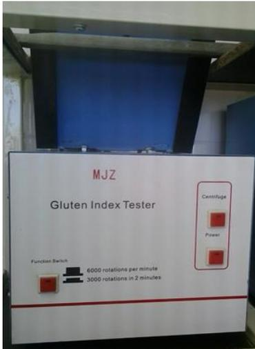
Figura 9: Centrifugadora Gluten Index
