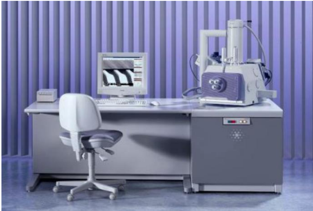
Ilustración 15. Equipo de SEM, PHILIPS/FEI XL -30, IMETMAT - UMSA.
