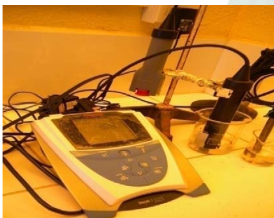
Gráfico 6. Equipo de pH. Electrodo de platino
