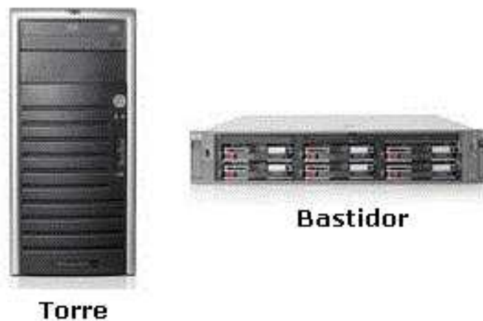
Figura 20 Servidor tipo Torre y Bastidor
