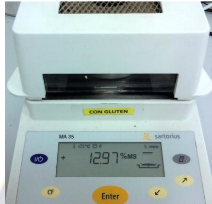
Figura 7. Balanza de humedad MA35 marca Sartorius
